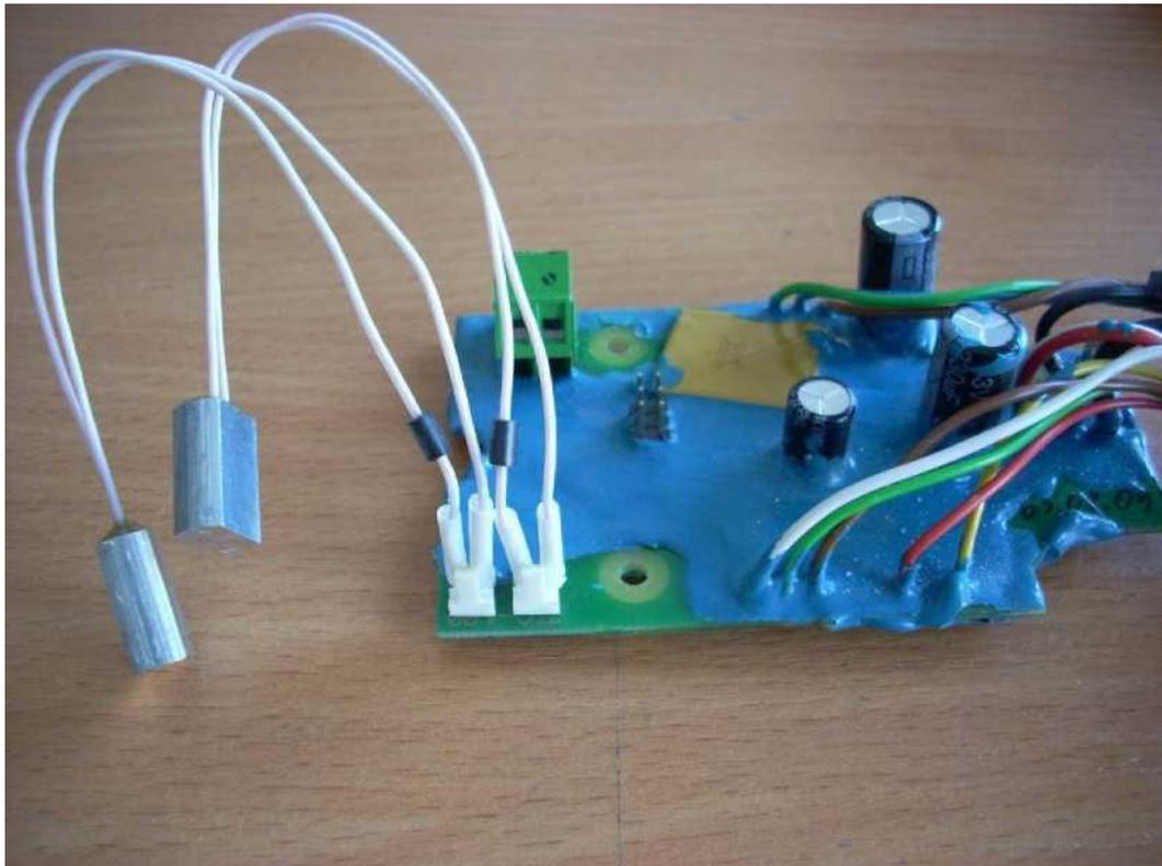
Для датчиков 2-го типа - провода с чёрными метками соединяются вместе и припаиваются к одному контакту.
