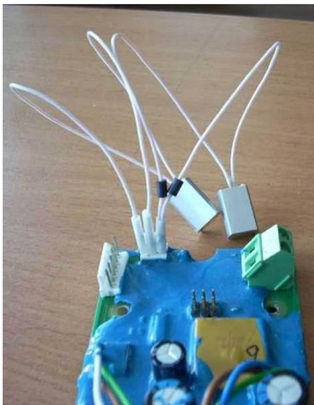
Для датчиков 3-го типа - отрезаем провода датчиков бокорезами обязательно замечая положение провода с чёрной меткой. Зачистите и залудите провода. Припаиваем к проводу с чёрной меткой провода с чёрными метками соединённые вместе не забыв предварительно надеть термоусадочную трубку. Оставшиеся провода припаиваем в произвольном порядке. После припаивания осадите термоусадочную трубку.
