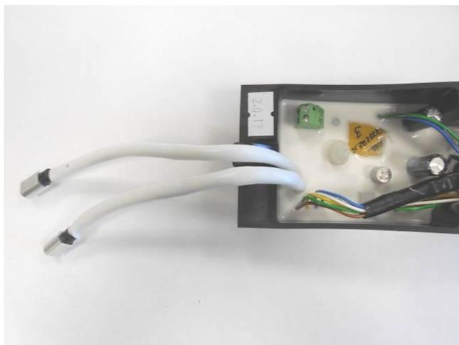
Новой прижимной пластиной закрепляем новые датчики (в произвольной последовательности).
