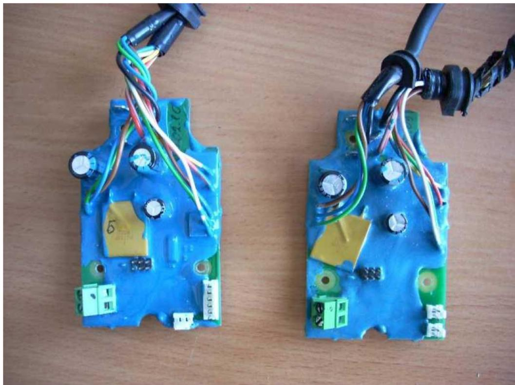
Плата с подключенными платами датчиков. Чёрными трубочками (колечками) помечены общие провода, такими же трубочками (колечками) помечены соответствующие провода на новых датчиках. В новых датчиках используются синий и черный провода. Черный провод соответствует черной метке на проводе.
